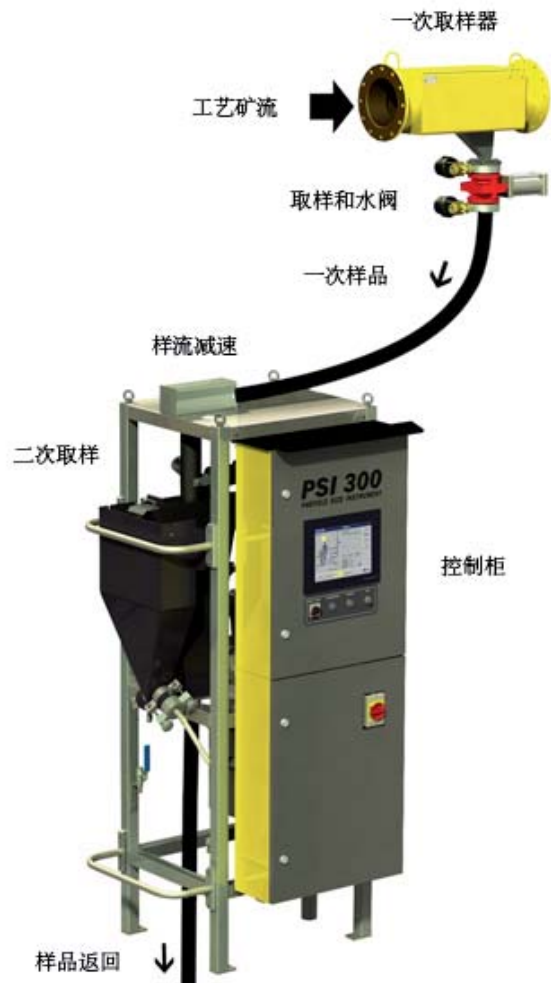
图1. 一个流道的 PSI 300™ 粒度分析仪，带有LSA一次取样器，远程控制取样阀，矿流减速和一个样品入口
